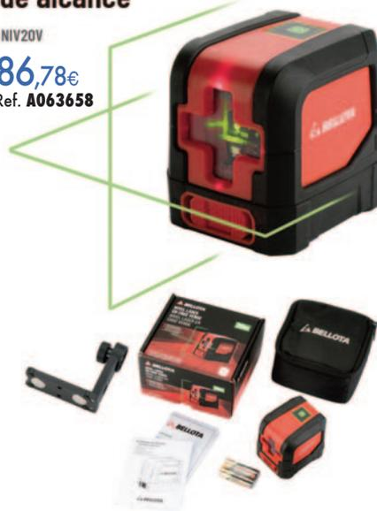
Apertura de haz de vertical 120° y haz horizontal 120° y autonivelante en superficies inclinadas de hasta 4°. Precisión de 0,3 mm/m y protección IP54 a salpicaduras de líquidos y polvo. Permite bloqueo del péndulo para garantizar el transporte y poder usarlo inclinado. Alarma visual cuando no está a nivel. Tiene rosca 1/4", incluye soporte magnético, funda, manual de instrucciones y 2 pilas 1,5V AA.
