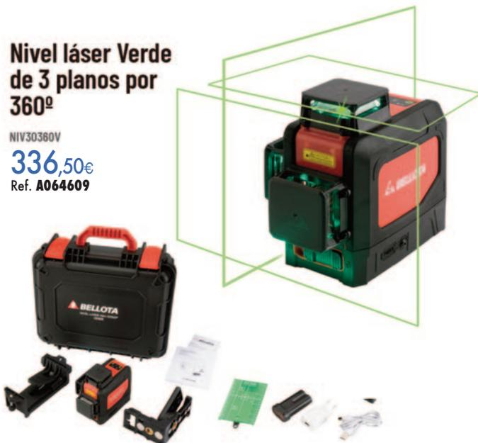
Autonivelante en superficies inclinadas de hasta 4°. Precisión de 0,3 mm/m y protección IP54 a salpicaduras de líquidos y polvo. Permite bloqueo del péndulo para garantizar el transporte y poder usarlo inclinado. Alarma acústica cuando no está a nivel. Tiene rosca 1/4", incluye maleta, soporte magnético, pinza, placa reflectora magnética, manual de instrucciones y batería Li-ion 3,7V 5200 mAh.
