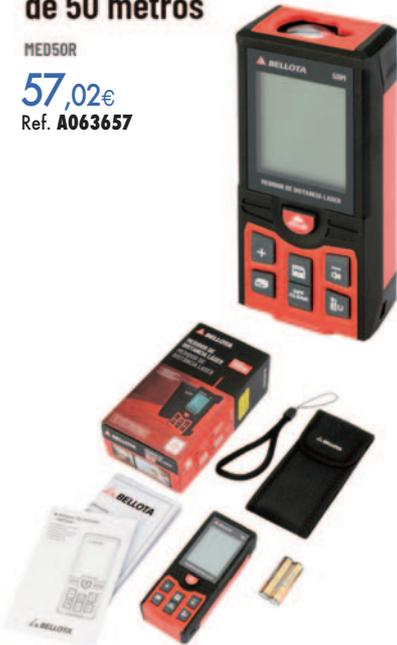
Precisión de 2 mm/m y protección IP54 a salpicaduras de líquidos y polvo. Permite medición continua, cálculo de suma y resta, área, volumen, función Pitágoras. Pantalla iluminada y 99 memorias. Incluye funda, correa y 2 pilas 1,5V AAA.
